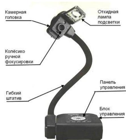
колесо ручной фокусировки, находящееся на головке документ-камеры. Вращая колесо в ту или другую сторону нужно добиться наиболее чёткого изображения на экране.
